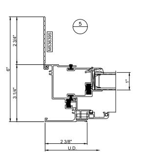
T500 **SERIES** CONFIGURATION SINGLE HUNG INTERIOR ANCHOR STRAP
