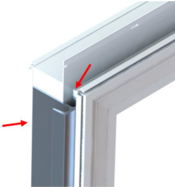
Aplica el parteluz en el lado de la ventana alineándolo con el compartimento del canal J. Asegúrate de que el parteluz no sobrepase el compartimento del canal J. Presiona firmemente para asegurar la cinta doble faz.
