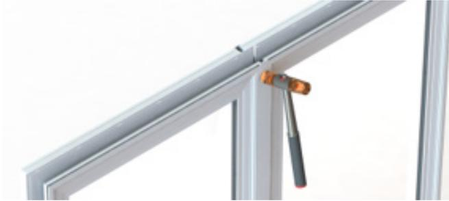
Instala el parteluz con una de las partes de la unidad y martíllalo en su lugar con un martillo de caucho. Da la vuelta la unidad y repite el procedimiento en el otro lado.
