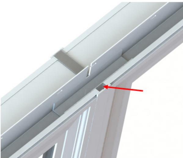
Aplica sellante en la parte inferior del borde del embudo de la jamba antes de instalar el compartimento del canal J en los dos terminales del parteluz, y añade sellante para tapar los espacios entre el embudo y el parteluz.
