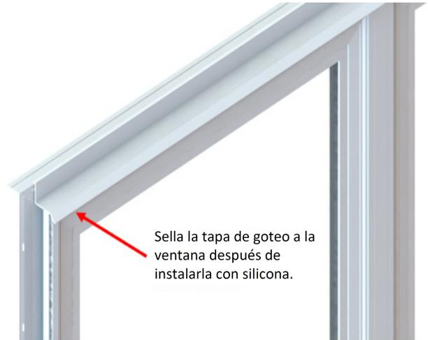
Instala la tapa de goteo sobre la aleta clavada en todo el largo de las unidades a ser instaladas. Muesca los terminales de la tapa de goteo de ser necesario de acuerdo a los estándares de instalación del canal J.
