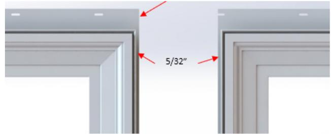
Utilizando una cuchilla multiuso remueve todas las aletas clavadas de cada unidad donde el parteluz se conecta con ellas. Asegúrate de cortar la cabecera y alféizar de las aletas clavadas hacia atrás con aletas clavadas rajadas.
