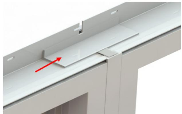
Aplica una pieza de embudo de aleta clavada de 5" a 7" en interior de la parte trasera de la aleta clavada en una capa de sellante.
