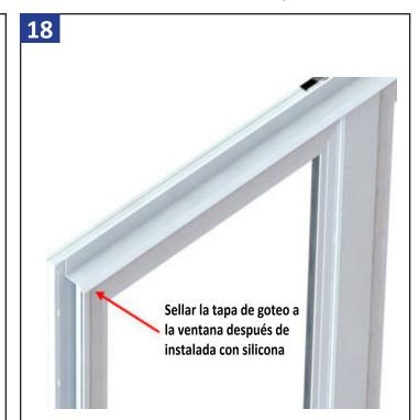
Después de que la unidad esté instalada en la pared, instale la tapa de goteo sobre la aleta clavada en toda la longitud de las unidades montadas en la cabeza. Haga una muesca en los extremos de la tapa de goteo si es necesario para las prácticas de instalación estándar del canal en J.
