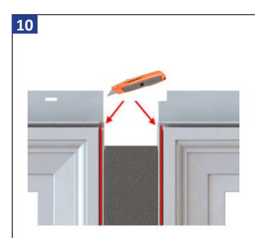
Si la unidad tiene un laminado aplicado, marque el laminado a través de la pista de la montura y retire el material para permitir que la llave de la montura encaje en su lugar.
