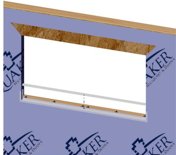
Instala la sección en declive asegurándote de que las nervaduras en el inferior se encuentren en las secciones del centro.
