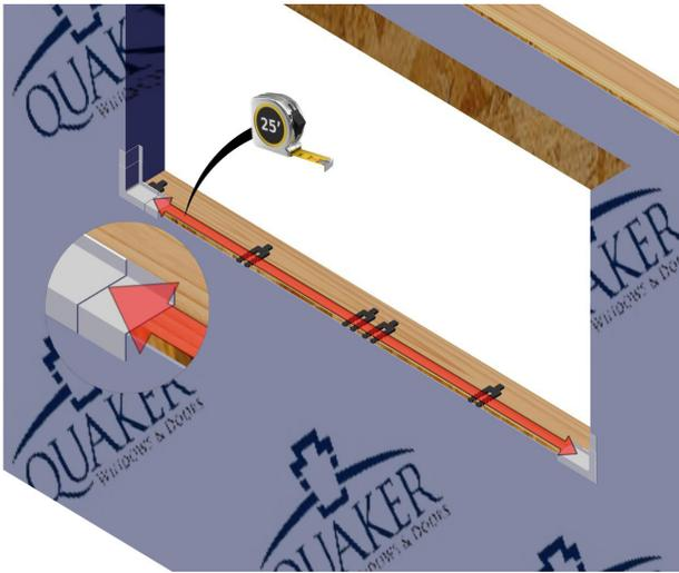
Mide y corta el centro de la sección del tapajuntas. Corta el lado que tiene 4" de muesca para tener al menos 2" restantes en cada lado. Instala en seco para asegurarte de que todo encajara correctamente con los restantes pertinentes antes del siguiente paso de la instalación.
