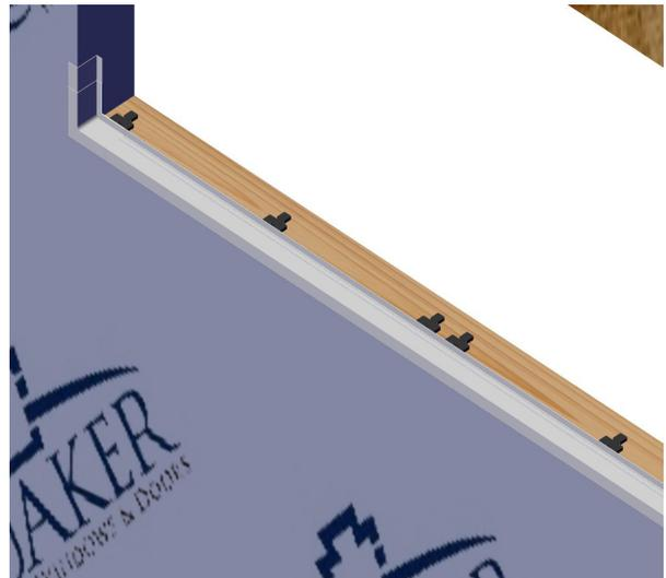
Ajusta la sección central del tapajuntas en su lugar presionando firmemente para permitir que el cemento pegue.
