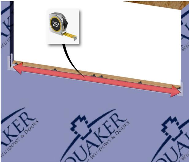
Mide entre los moldes de las esquinas y corta la sección en declive a 1" o menos para las curvas en las esquinas.
