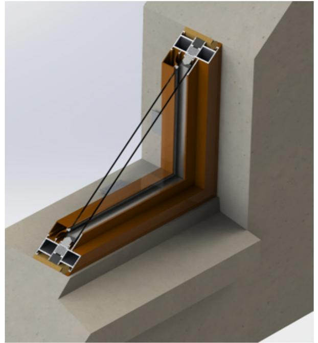
Acciona la ventana para aseg r que funcione correctamente. La banda no funcionara adecuadamente si la venta se encuentra descuadrada, demasiado acuñaada o aislada. Permit que la espuma se seque completamente antes de instalar la moldura interior sobre los clips. Instala los terminados.
