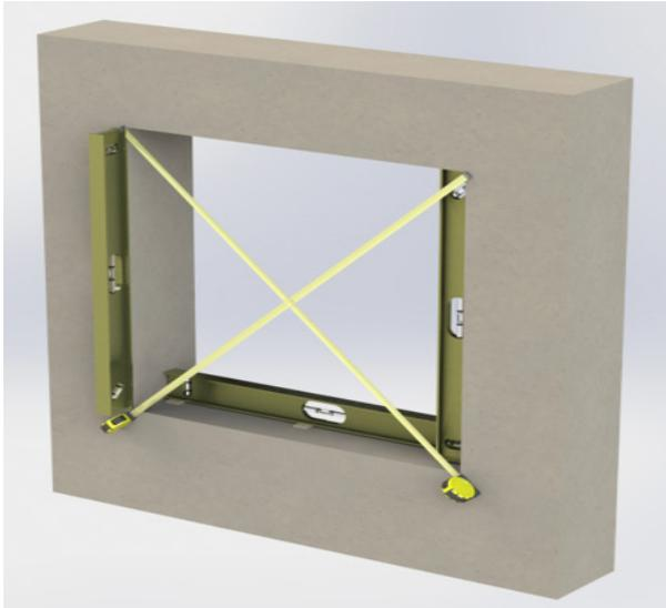
Mide y asegúrate del tamaño del vano. El vano debe ser al menos  $\frac{1}{2}$ " (sin exceder 1") más ancho y más largo que la unidad. La apertura de mampostería debe ser de  $\frac{1}{2}$ " más ancha y  $\frac{9}{16}$ " más alta que el marco. Asegúrate de que el vano se encuentre liso, instalado, nivelado, y cuadrado. Toma medidas diagonales para revisar que se encuentre cuadrado. El alféizar debajo de la unidad debe encontrarse nivelado para una operación apropiada de la unidad.
