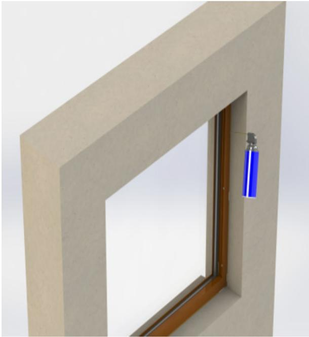
Aisla entre el marco de la ventana y el vano usando espuma de expansión y espuma para puertas o aislante de fibra de vidrio que cumpla con las regulaciones AAMA 812-04. Lee y s las recomendaciones del fabricante para su uso y aplicación.
