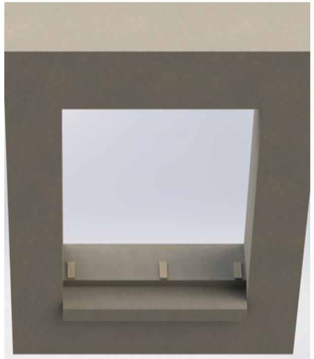
Revisa el ajuste de la unidad para asegurarte de que las condiciones se encuentran niveladas, el contratista puede pre instalar las cuñas al alféizar previo a la instalación del marco de la ventana.
