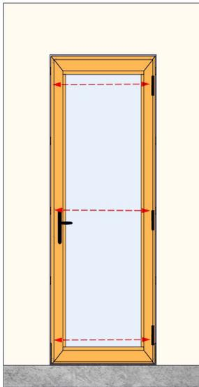
Verifica que la puerta se encuentre cuadrada, nivelada, e instalada. Revisa el espacio alrededor de la puerta y el borde superior, en la mitad, y el borde inferior para asegurarse de que la puerta no esté demasiado acuada. Revisa los manuales de bisagras y puntos de cierre en caso de necesitar ajustes extras.
