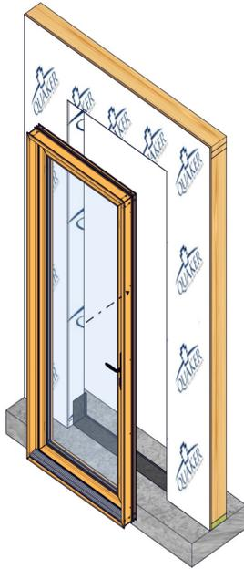
Centra e instala el marco de la puerta en el vano. Asegúrate de conservar la puerta plana con el interior terminado de la pared. Nivelá con el alféizar e instala el marco. Acuña por debajo del marco para traer la puerta al nivel necesario.
