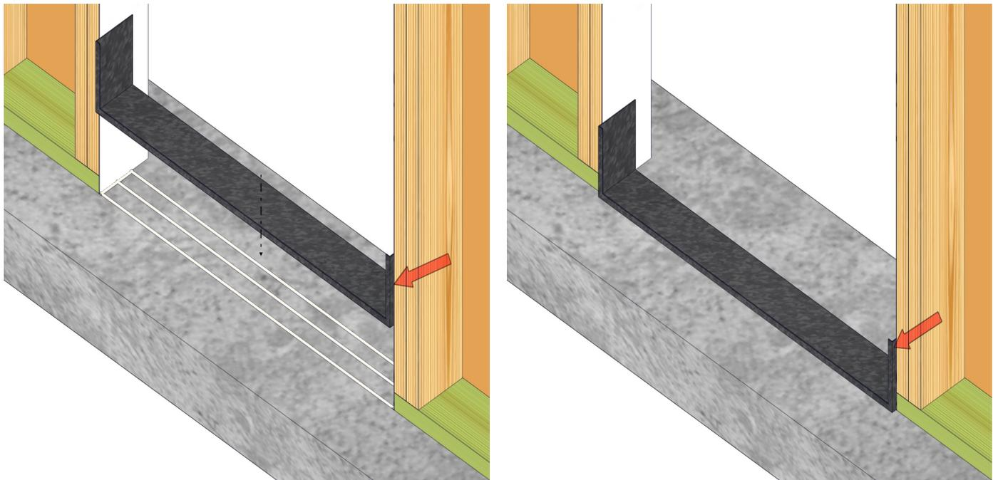
Instala el umbral de charola (por otros). En caso de instalarse la puerta plana con el interior para permitir un movimiento de la puerta de 180°, asegurarse de instalar el umbral de charola con interior de la pared terminado.
