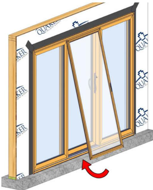
Incline el panel de la pantalla con la parte superior insertada en el carril del cabezal, y luego levante y coloque los rodillos inferiores en el carril de rodillos. Ajuste los rodillos según sea necesario para asegurar que el panel esté nivelado, cuadrado y se deslice suavemente.
