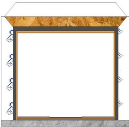
Aplique un cordón de sellador de 3/8" en el borde exterior superior del marco de la puerta antes de instalar la tapa de goteo.
