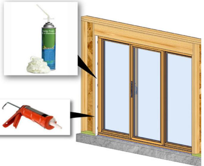
Rellene 1/3 interior de la cavidad con espuma de baja expansión o varilla de soporte y aplique el sellador de forma continua alrededor de todo el perímetro de la abertura.
