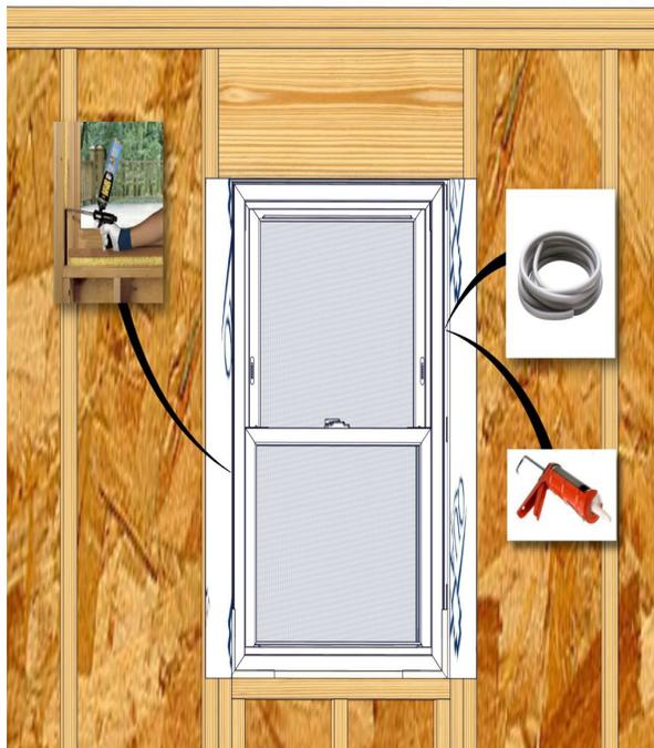
Aplica sellante continuamente alrededor del perímetro completo del vano, llenado el interior 1/3 de la cavidad usando espuma de expansión, esponja protectora o sellante.
