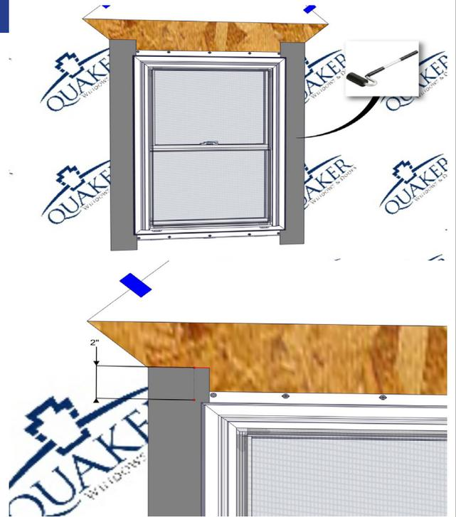
Aplica impermeabilizante en los lados de la ventana, dejando sobrante como se indica en la imagen. Aliza usando un rodillo J. Extiende la cinta en un mínimo de 2" sobre el marco de la ventana.
